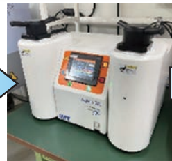
自動埋め込みプレス機 試料の樹脂埋め込み
